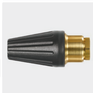
1/4" F. Spray angle 20°. 120 - 250 bar. Max. 100 °C
